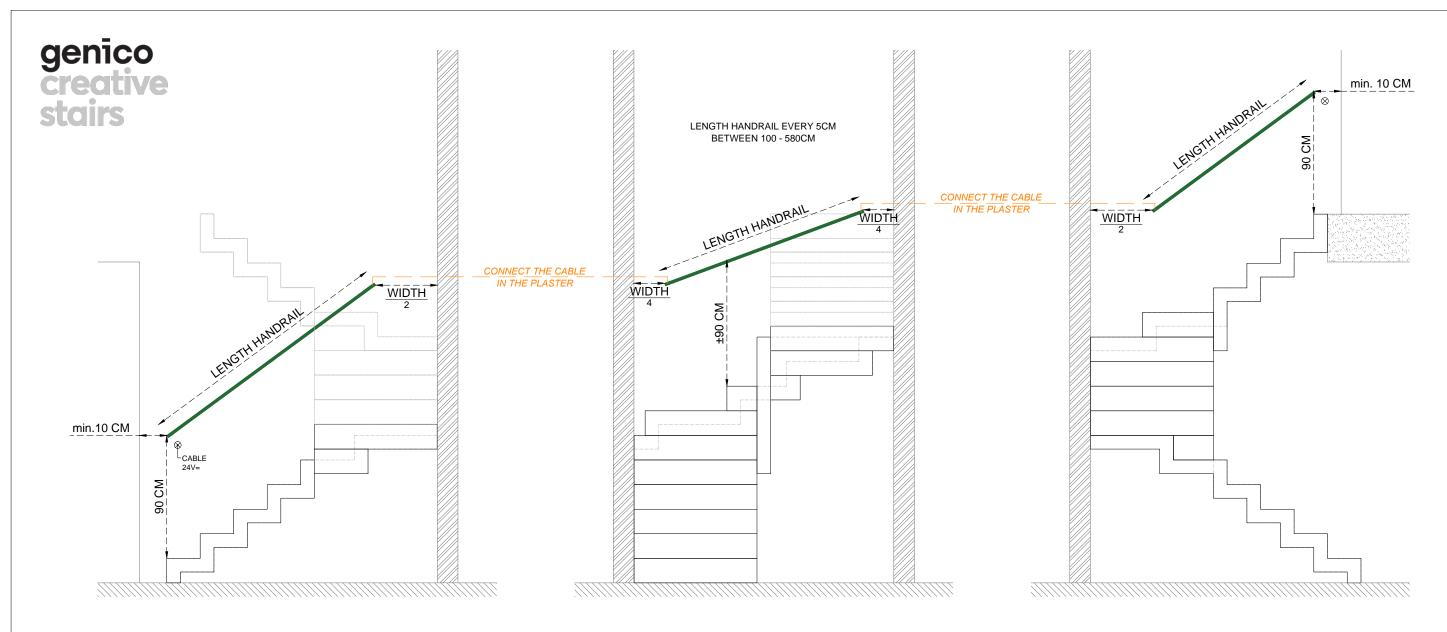
$\otimes$  CABLE AT THE BOTTOM <u>OR</u> ON TOP OF THE STAIRCASE
